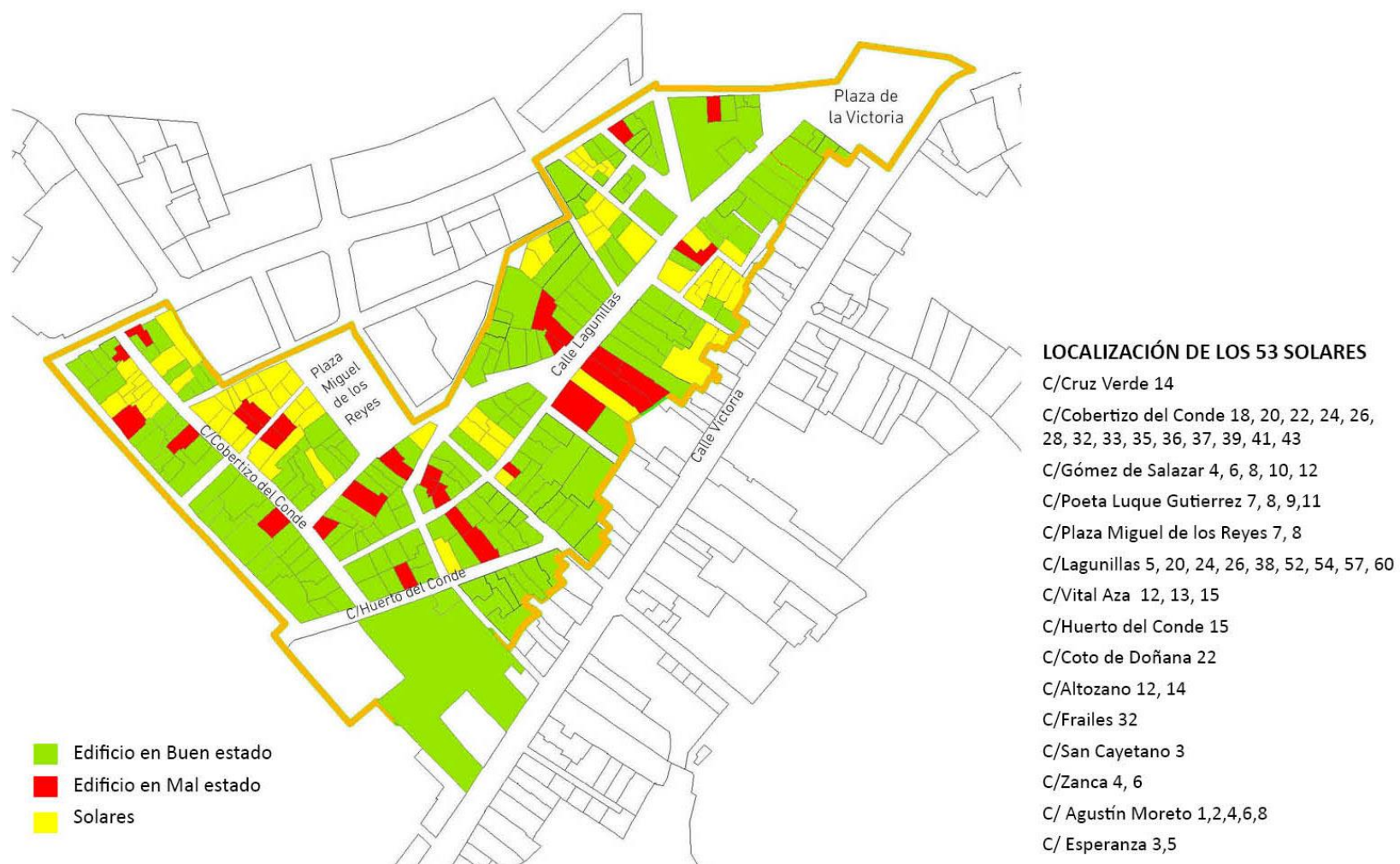
Fig. 5.6: Localización de los solares y estado de conservación de los edificios
